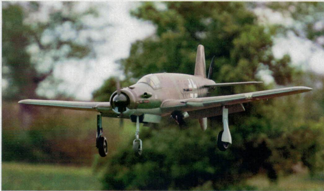
Ce Do 335, piloté par Roland Sabatschus, est un bimoteur push-pull. Il est équipé d'un moteur Titan 62 cc dans le nez et d'un Titan 45 cc au milieu du fuselage, un arbre de 1 m de long le reliant à l'hélice arrière....
